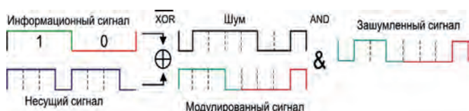
Рисунок 4. Схема модуляции сигнала: \oplus – оператор суммы по модулю 2; \& – оператор логического умножения (конъюнктор).
