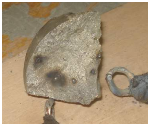
Рис. 3. Зоны пробоя куска при воздействии электрического заряда
