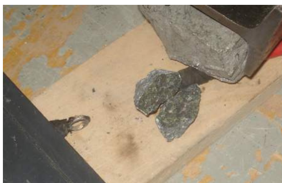
Рис. 4. Разрушение куска при воздействии электрического заряда
