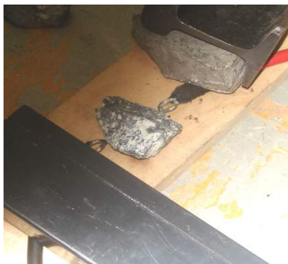
Рис. 2. Схема установки электродов на куске
