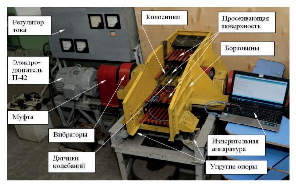
Рисунок 1. Общий вид стенда грохота. Figure 1. General view of the screen stand.
