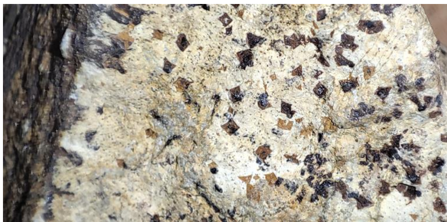
Рисунок 2. Фото образца керна с забоя скважины 1: размер поля 2 × 4 см: выветренный березит с вкрапленниками окисленных сульфидов и анкерита
