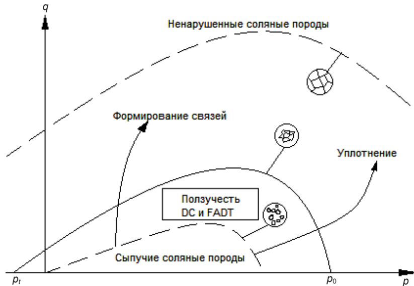
Рисунок 5. Механизм деформирования раздробленных соляных пород в осях девиаторных и средних напряжений [24] Figure 5. Mechanism of deformation of crushed salt rocks in the axes of deviatoric and average stresses [24]
