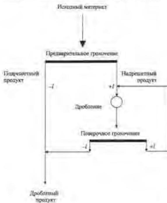
Рис. 1. Схема предварительного и поверочного грохочения при дроблении
