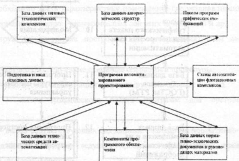
Рис.1. Обобщенная структурная схема составных частей алгоритма автоматизированного проектирования схем автоматизации
