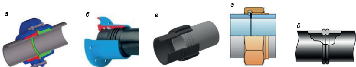
Рисунок 1. Примеры соединений полимерных труб. а – фланцевые фрикционные; б – фланцевые резьбовые; в – прессовые; г – с накидной гайкой; д – соединенные с помощью сварки.
