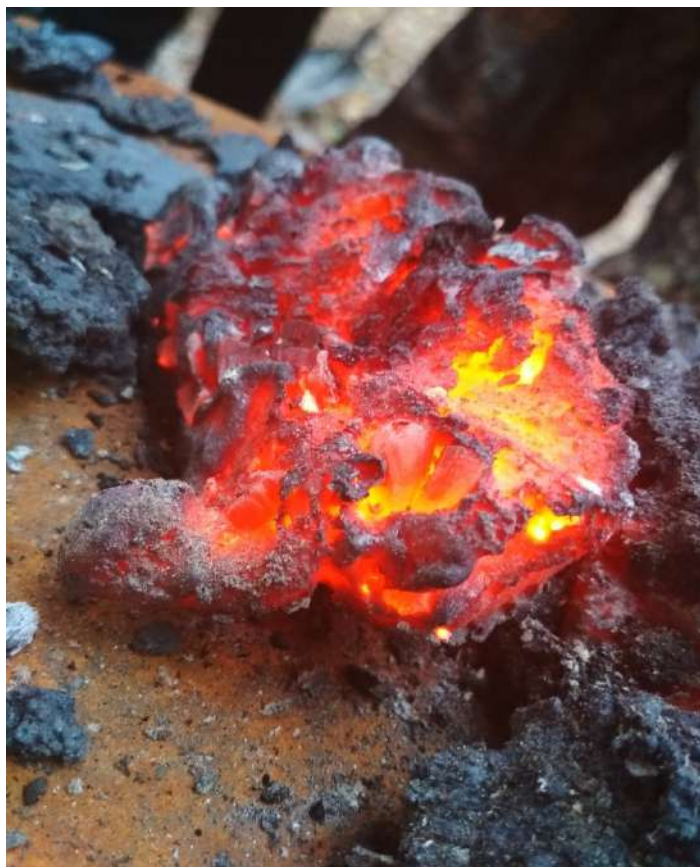
Железная крица. Металлургический эксперимент. «Олень ручьи», 28 октября 2018 г. Фото Е. Русяевой.
