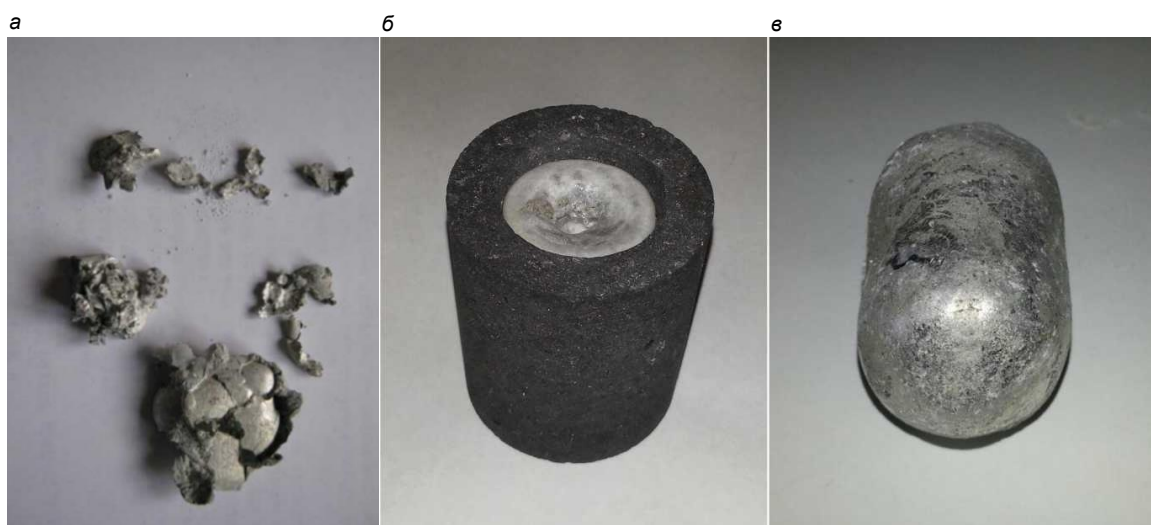
Рисунок 7. Полученный в ходе опыта металлический магний из карналлита Нивенского месторождения полиминеральных солей: а – капли металлического магния из расплава; б – отливка металлического магния в форме; в – слиток металлического магния Figure 7. Metallic magnesium obtained during the experiment from the carnallite of the Nivensky deposit of polymineral salts: a – drops of metallic magnesium from the melt; b – casting of metallic magnesium in the form; c – an ingot of metallic magnesium
