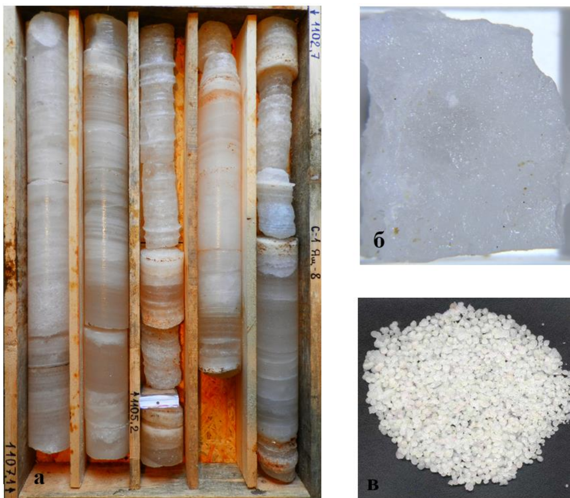
Рисунок 3. Исходное сырье для получения металлического магния: а – карналлитовый керн Калининградско-Гданьского солеродного бассейна; б – проба карналлита; в – проба бишофита
