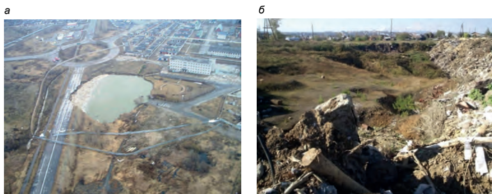
Рисунок 1. Провалы в промышленных зонах. а – провал в промзоне г. Березники (Пермский край), 2007 г.; б – большой провал в г. Краснотурьинске (пос. Медный), 2005 г.
