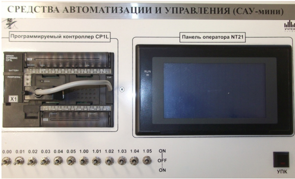
Рисунок 4. Стенд сенсорного монитора оператора и контроллер / Figure 4 | Platform of touch monitor and controller.
